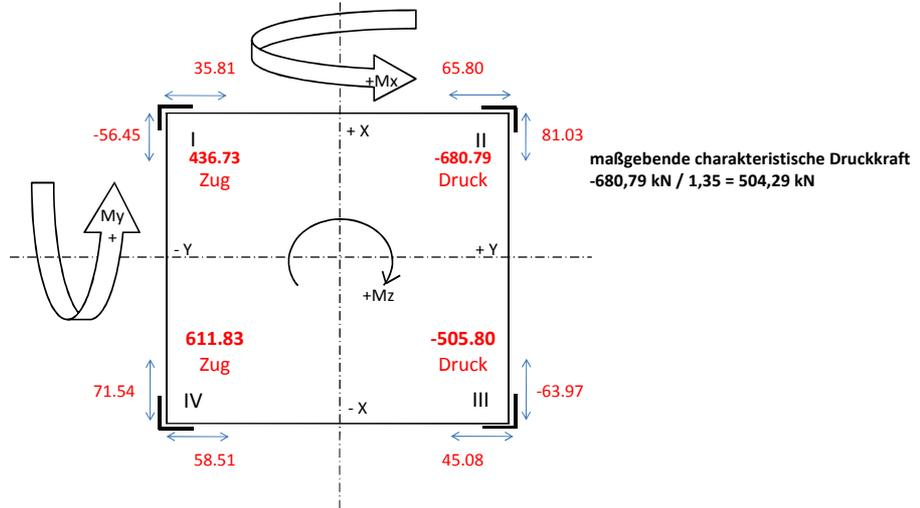
**2.) Übersicht der Auflagerkräfte aus Lastfall Ha-1:** ( Alle Werte einschl. Teilsicherheitsbeiwert / Vertikallasten \*1,00)
